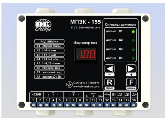
Для оперативного анализа причины возникновения аварии в МПЗК-155 используются коды аварий. При возникновении аварии происходит отключение цепи управления электродвигателем и на цифровом светодиодном индикаторе отображается код аварии в буквенно-цифровом виде.
