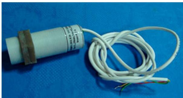
Емкостной датчик ВБШ – 03 используется в качестве датчика подпора, датчика заполнения бункера для контроля заполнения резервуаров жидким, порошкообразным или зернистым веществом, а также, как конечный выключатель на автоматизированных линиях, конвейерах, станках, в системах сигнализации, для позиционирования различных механизмов и т. д. (аналог типа, ВБЕ и т. д.).
